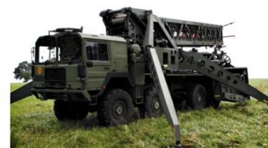
**Bild 2:** Dank der vier massiven Standbeine und dem Gewicht von 30 t könnte der 40 m hohe Mast auch Windgeschwindigkeiten von 120 km/h trotzen
