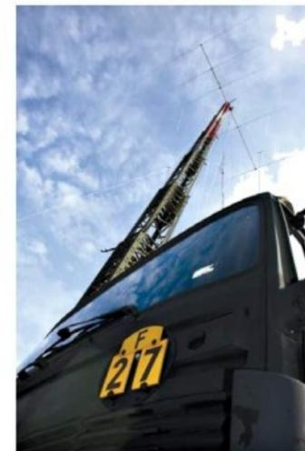
**Bild 4:** Die Monoband-Yagi nach der Installation auf dem 40-m-Mast des MAN 8x8 Trucks
